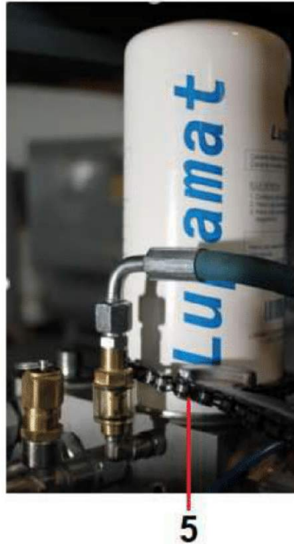
Рисунок-9 Снятие фильтрующего элемента масляного фильтра
