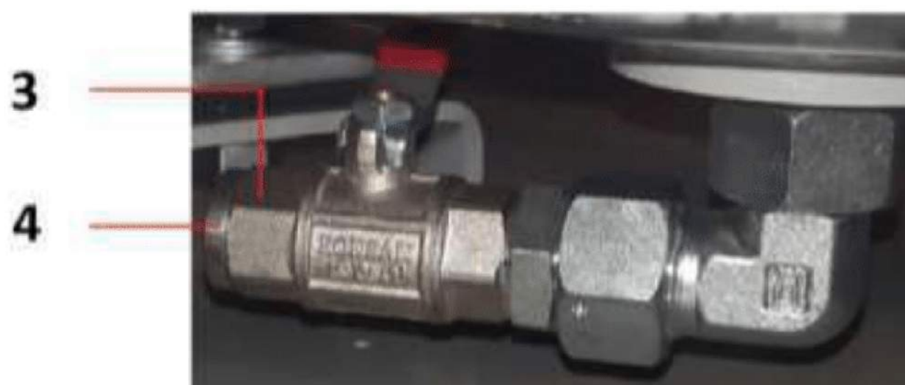
Рисунок-8 Клапан слива масла (3) и пробка (4) сепараторного бака
