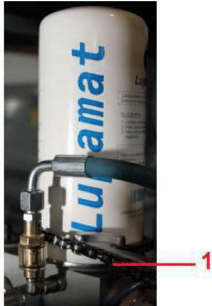
Рисунок-12 Замена навинчиваемого разделителя
